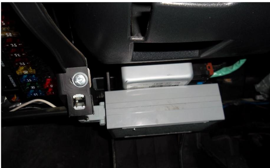
Рисунок 4 – Место установки устройства учета фактической наработки зубчатого ремня привода ГРМ на автомобиль
