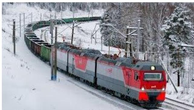
Рисунок 4 – Электровоз 3ЭС10 «Гранит» с бустерной секцией
