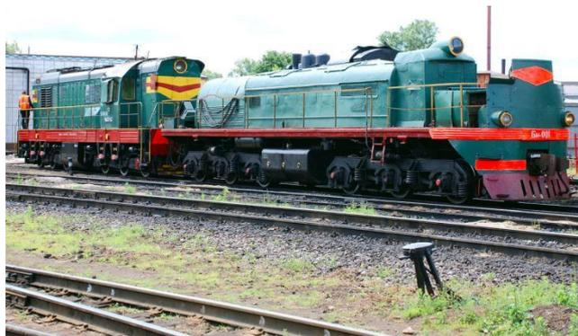
Рисунок 3 – Бустерная секция ЧМЭЗБ
