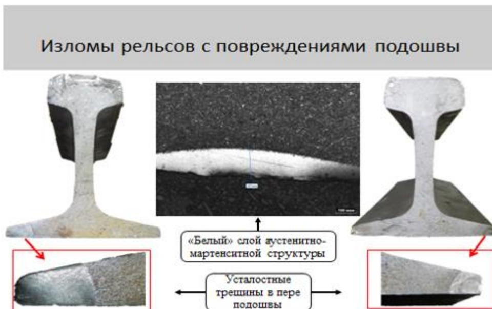
Рисунок 4 – Характерные виды повреждений подошвы рельса
